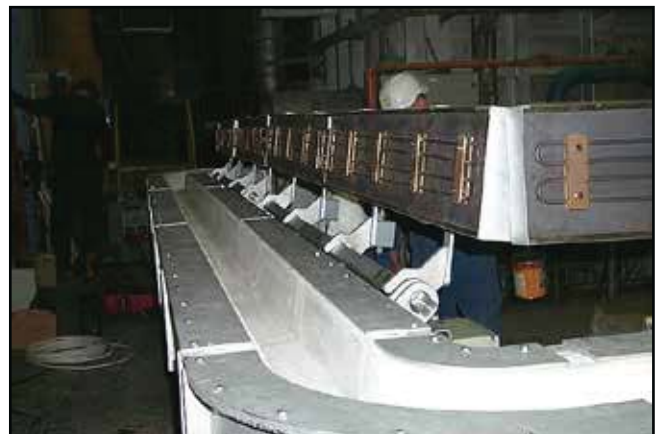
SISTEMA DE CANALES VERTEDORES CALENTADOS Y CUBIERTOS
