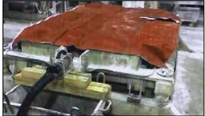
CUBIERTA AISLADA EN LA MESA DE COLADA DE TOCHOS (CILINDROS)
